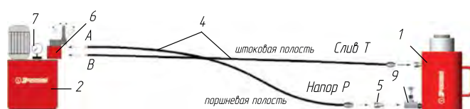
Система с одним рабочим механизмом двухстороннего действия, работающим от насосной станции с электро-, бензо-, пневмоприводом
